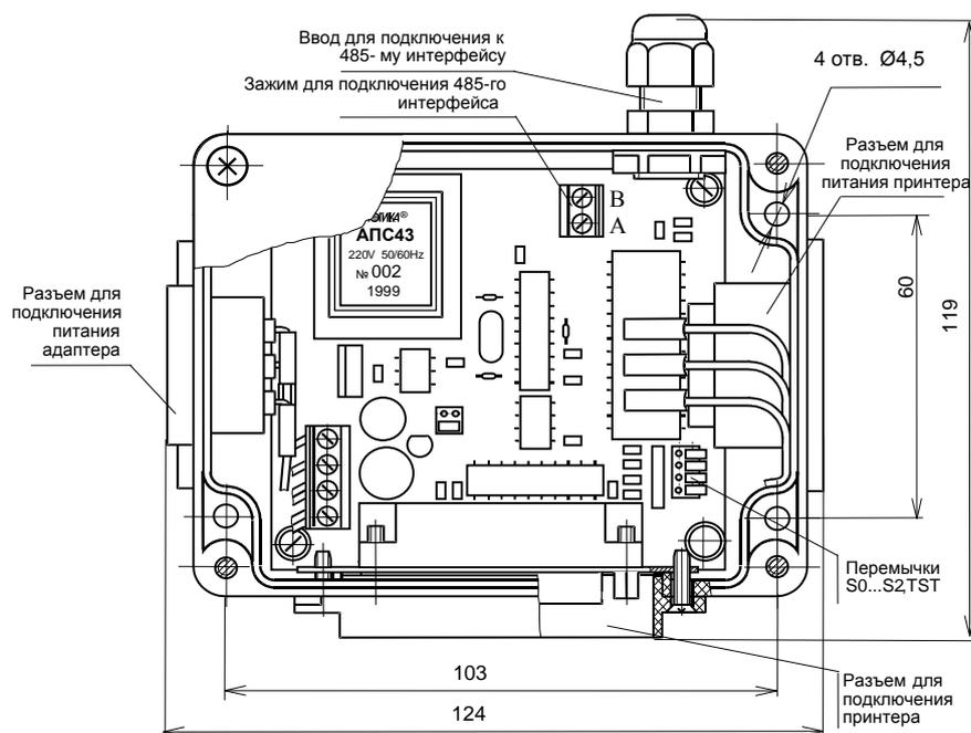
Рисунок 1 - Присоединительные размеры корпуса адаптера АПС43
